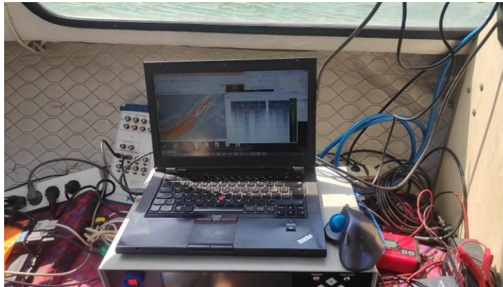
Figura 53 Sistema de adquisición y navegación durante el levantamiento sísmico.
