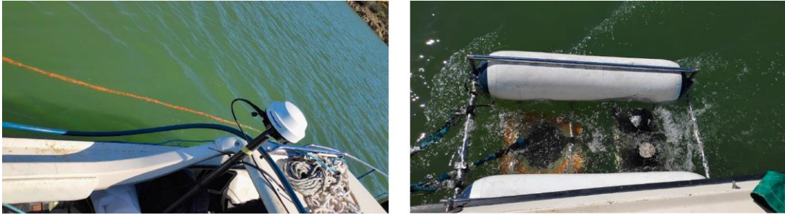
Figura 55 Equipo geofísico instalado en el barco
