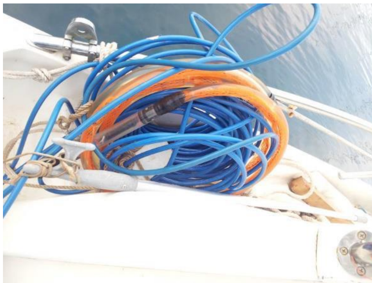
Figura 37. Hidrófono receptor acústico o Streamer
