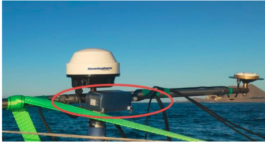
Figura 10. Sensor de movimiento y GPS integrado en el soporte de la ecosonda multihaz.
