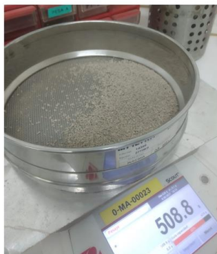
Figura 80 Pesaje de los distintos tamices.
