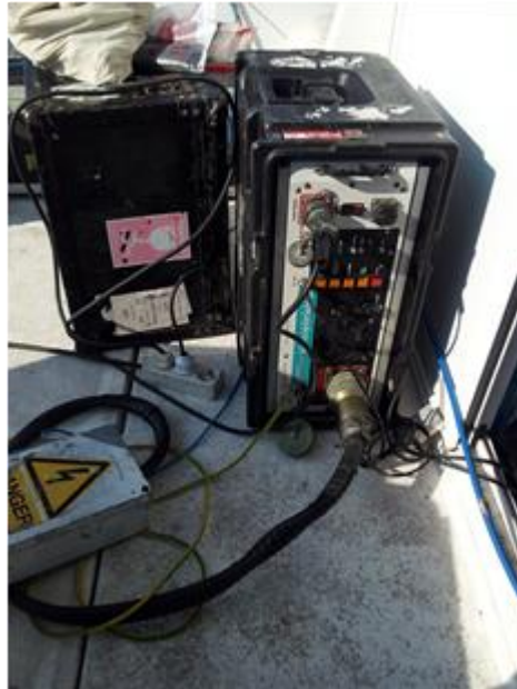
Figura 34. Fuente de alimentación del emisor sísmico.
