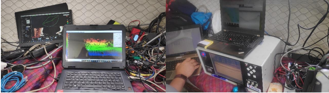
Figura 26 Ordenador de control de navegación con pantalla del operador instalado a bordo. Batimetría + LIDAR (izda) y sísmica (dcha).
