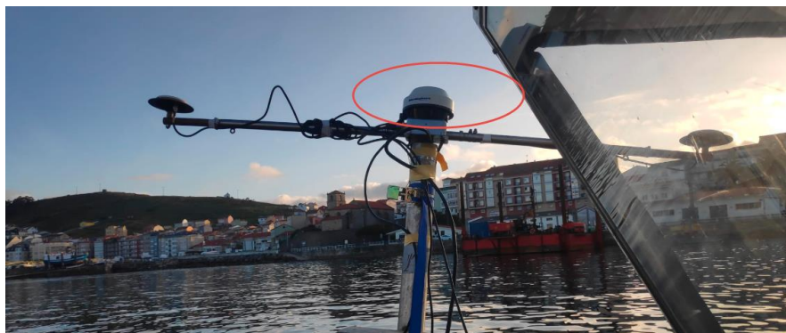
Figura 22 Embarcación con el mástil dónde se instala la antena GPS Rover
