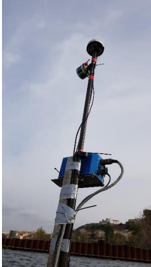
Figura 32 Velodyne VLP16 integrado en el mástil junto a la ecosonda y al sistema MRU+GPS RTK.
