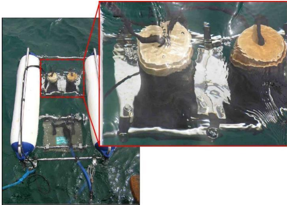
Figura 39. Receptor de 3.5KHz asociado al Geopulse
