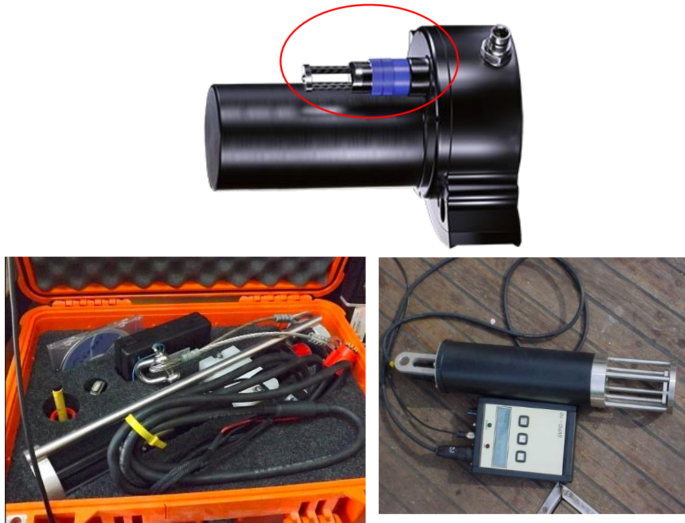
Figura 30 Sensor de la velocidad del sonido en superficie (arriba). Sensor de velocidad del sonido en la columna de agua (abajo.).
