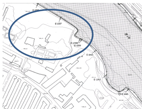
Figura 7: La línea que marca el límite del DPH no es la que propia de un cauce sin intervención artificial
